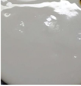
图 1 与陶瓷基体结合的高阻涂层
